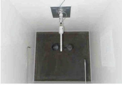
Photo of the Anemometer in the Wind Tunnel Laboratorio de Calibración en Túnel Aerodinámico, LAC, IDR/UPM Instituto Universitario de Investigación Tecnológica Da River Página 5 de 5 28344C
